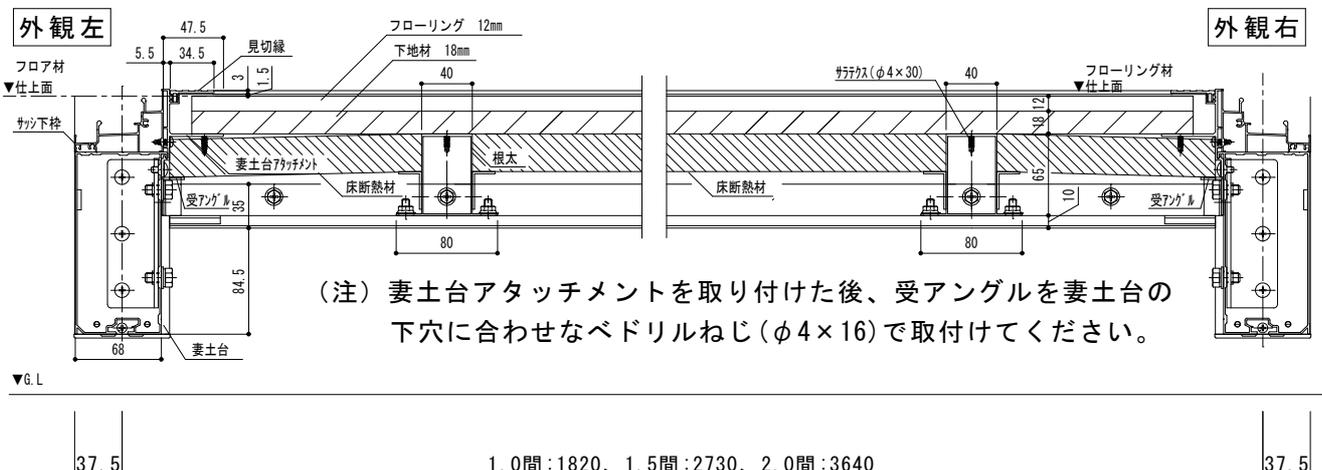
(注) 妻土台アタッチメントを取り付けた後、受アングルを妻土台の下穴に合わせなべドリルねじ(φ4×16)で取付けてください。
