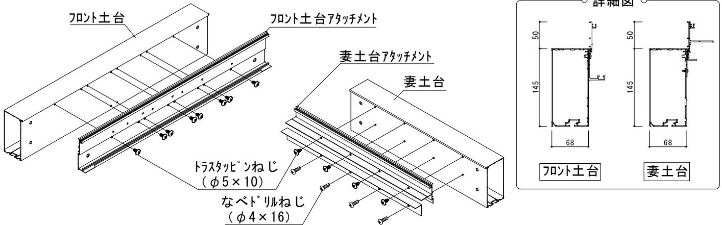
※出幅 6 尺以上の場合、中間に大引・束を取付けてください。（出幅 3～5 尺の場合は不要）
