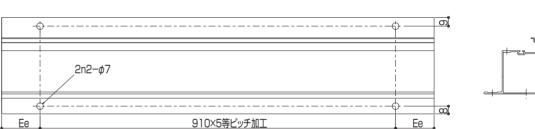
%1: 当該 $\phi$ 4.5穴以外は斜線部の切断前にケガいてください。 ※2:柱移動した場合は、柱の移動分穴位置をずらしてください。
