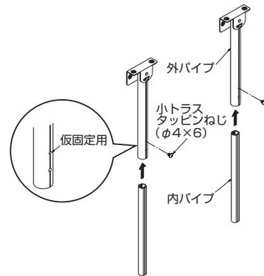
3. 内パイプを竿掛けに挿入し、ねじで取付けてください。
