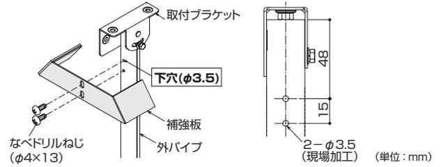
2. 内パイプを竿掛けに挿入し、ねじで取付けてください。
