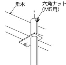
3. 取付ブラケットをL形ボルトに挿入し、六角ナットで固定してください。
