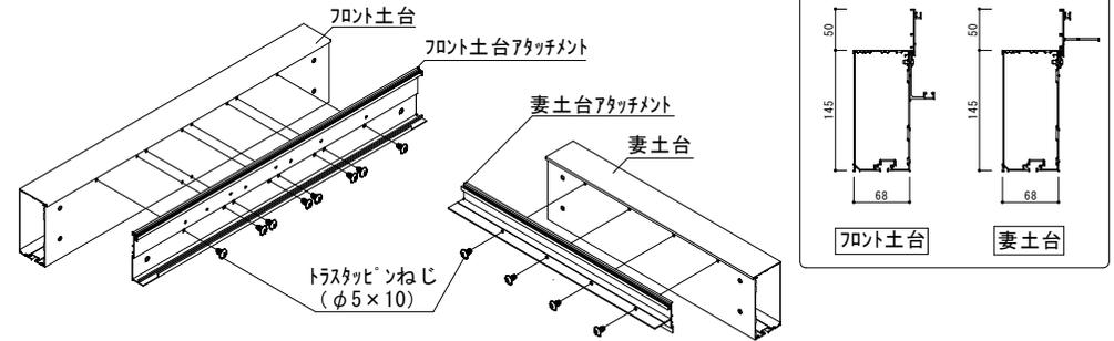
※出幅6尺以上の場合、中間に大引・束を取付けてください。(出幅3～5尺の場合は不要)
