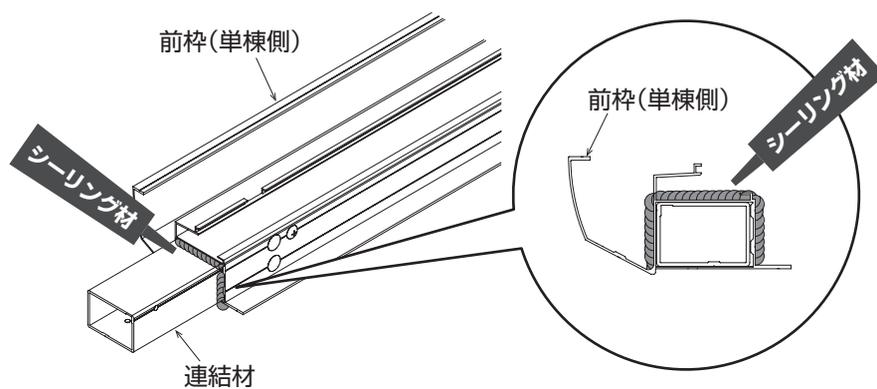
3. 連棟側の前枠を単棟側の前枠連結材に取り付けてください。
