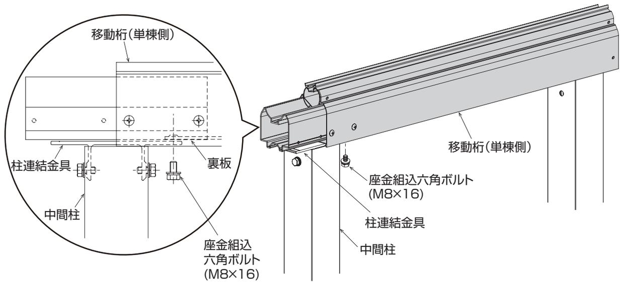
3. 連棟側の移動桁を単棟側の移動桁の連結材に挿入してください。
