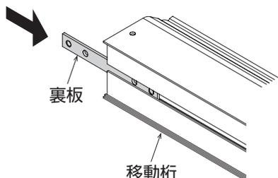
2.柱連結金具を移動桁に取り付けてください。
