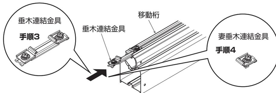
5.桁キャップを移動桁に取り付けてください。
