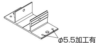
3.垂木連結金具を移動桁に挿入してください。
