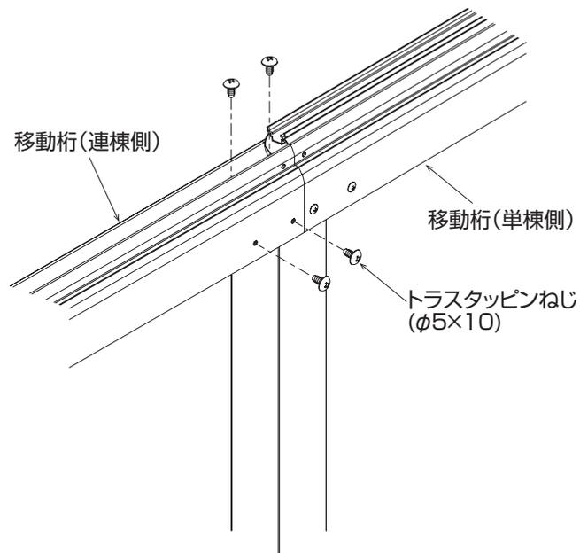
6. 桁キャップを単棟側の移動桁外観左側と連棟側の外観右側の移動桁に取り付けてください。
