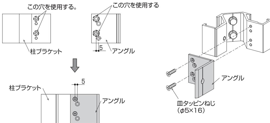
3. 柱が垂直になるように、柱ブラケットと柱面の間に調整ライナーを差し込んで調整してください。
