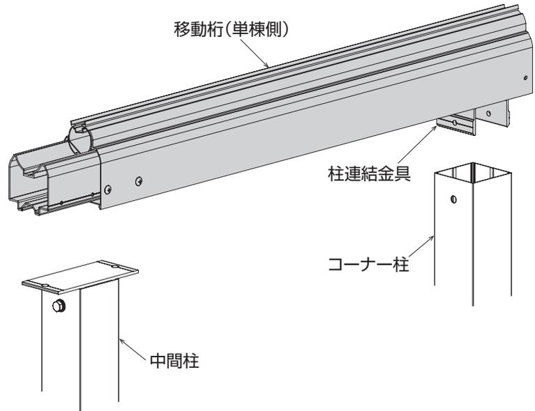
2. 単棟側の移動桁を中間柱の柱連結金具に仮留めしてください。
