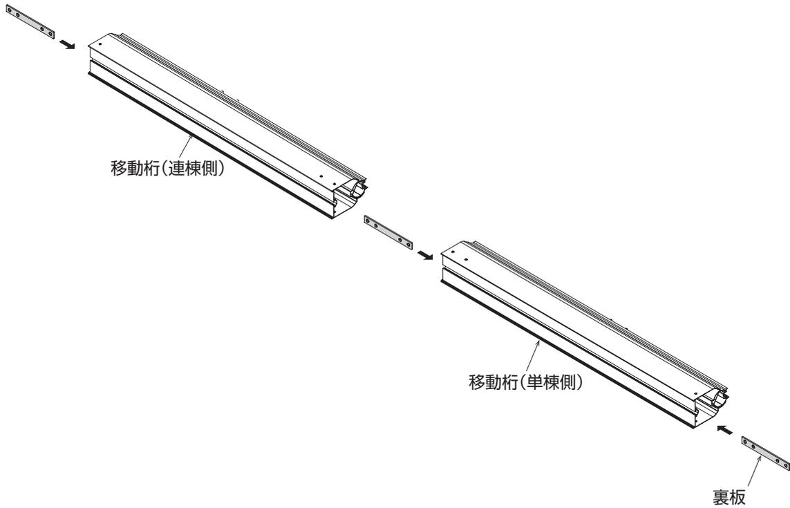
2.柱連結金具を単棟側の移動桁外観左側、連棟側の移動桁外観右側に取り付けてください。
