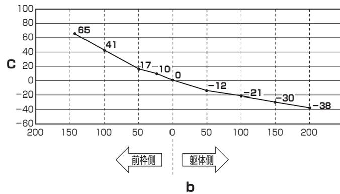
例：600N/m<sup>2</sup> 2.0間4尺のRタイプを躯体側に100mm出幅移動したい場合の長さを求める。
