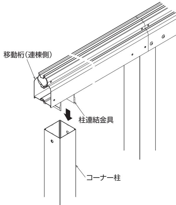
5. 連棟側の移動桁を単棟側の移動桁の連結材に取り付けてください。
