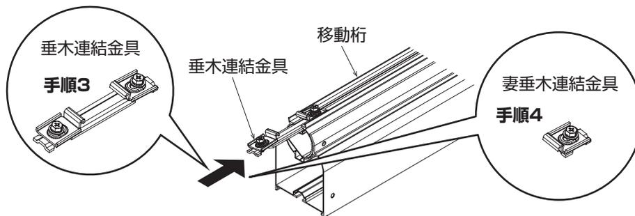
5. 連結材を単棟側の移動桁に取り付けてください。
