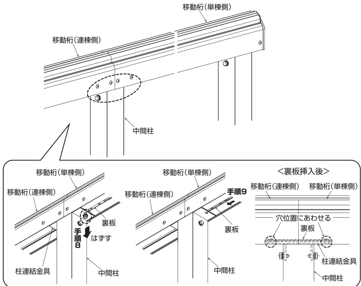
10. 単棟側と連棟側の移動桁を中間柱に取り付けてください。
