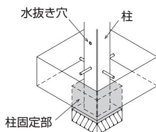
②土間および基礎コンクリートを同時打設・養生してください。
