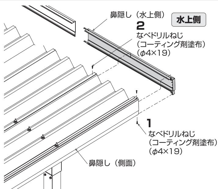
**3** もう一方の鼻隠し（水上側）を折板にかぶせ、鼻隠し連結金具で連結してください。
