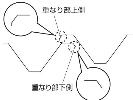
2 折板を折板取付ナットで固定し、ボルトキャップをたたき込んでください。
