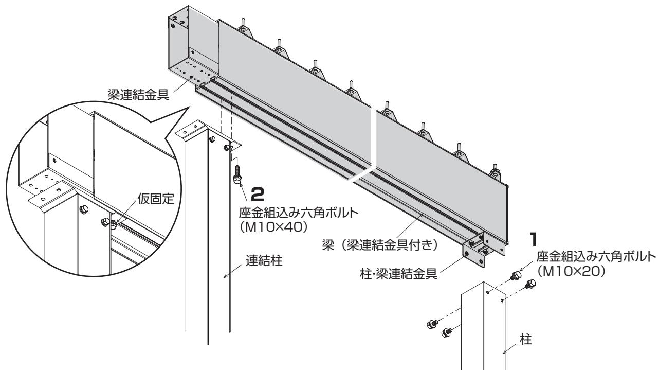
**3** 柱・梁連結金具を柱に挿入し、もう一方の梁を柱に固定してください。
