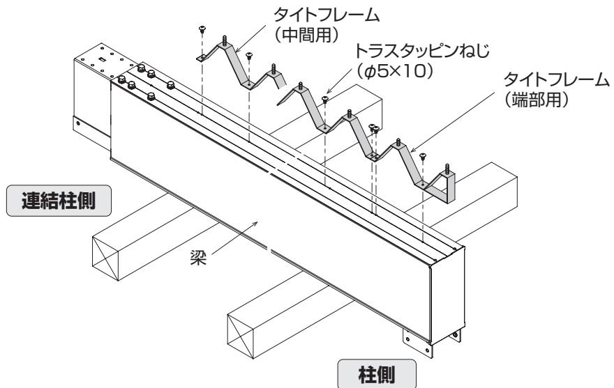
**5** 柱・梁連結金具を柱連結材に取り付けてください。
