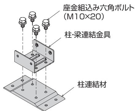
**6** 柱・梁連結金具を連結柱に取り付けてください。
