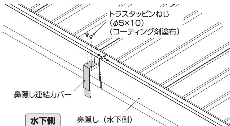
**8 鼻隠し補強部品（水下）を鼻隠し（水下側）に取り付けてください。**
