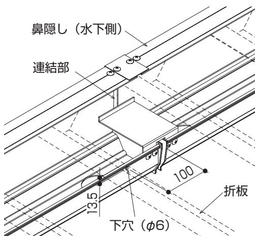
③ 鼻隠し補強部品（水下）を鼻隠し（水下側）にねじで取り付けてください。
