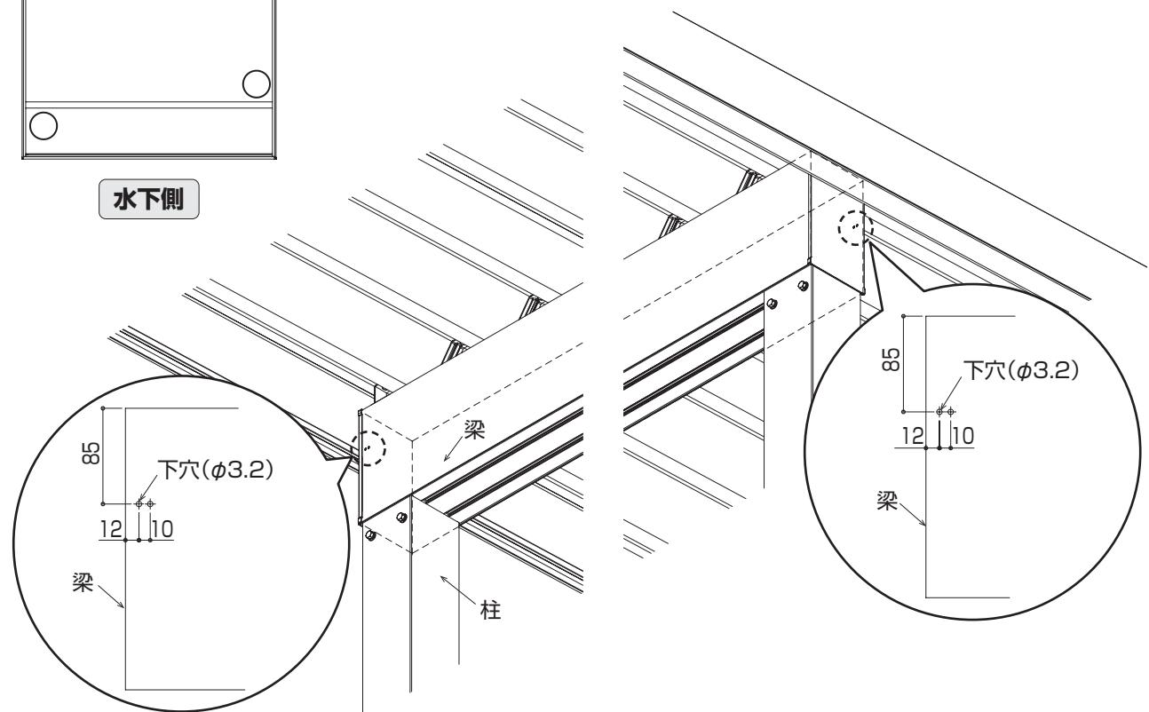
2 鼻隠し補強部品（側面）を梁に取り付けてください。
