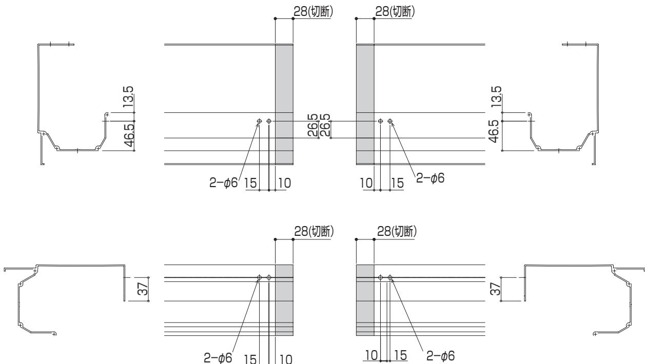
2 止水板を鼻隠し（水下側）に取り付けてください。
