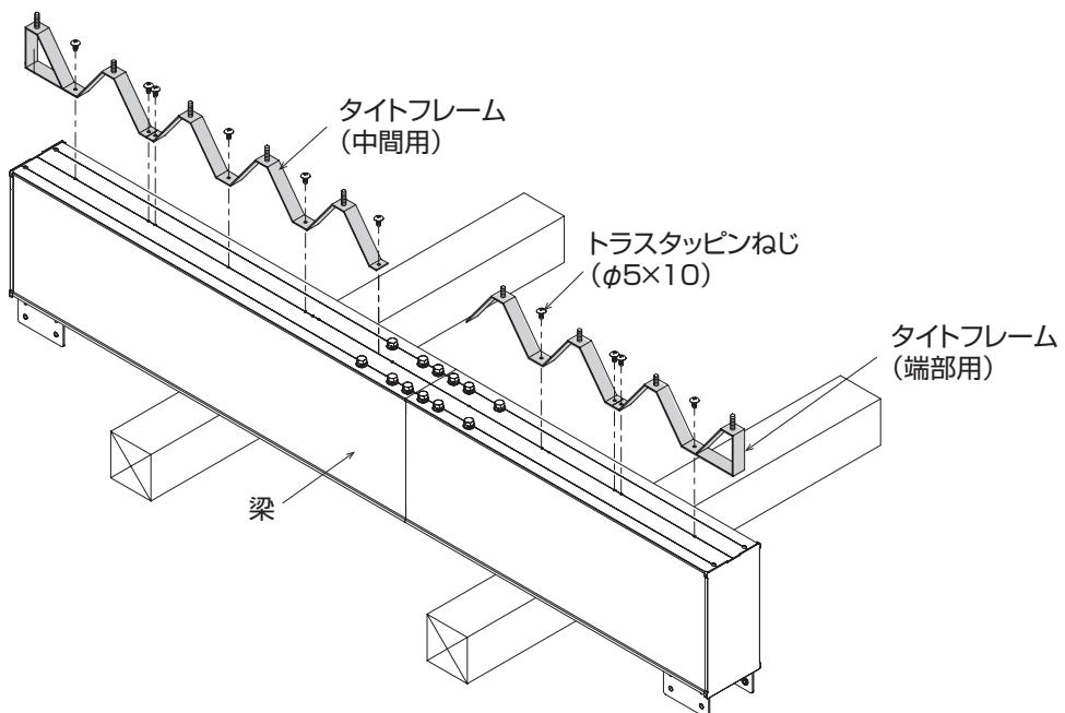
**8** 梁連結カバーを梁見付けにあわせて切断してください。
