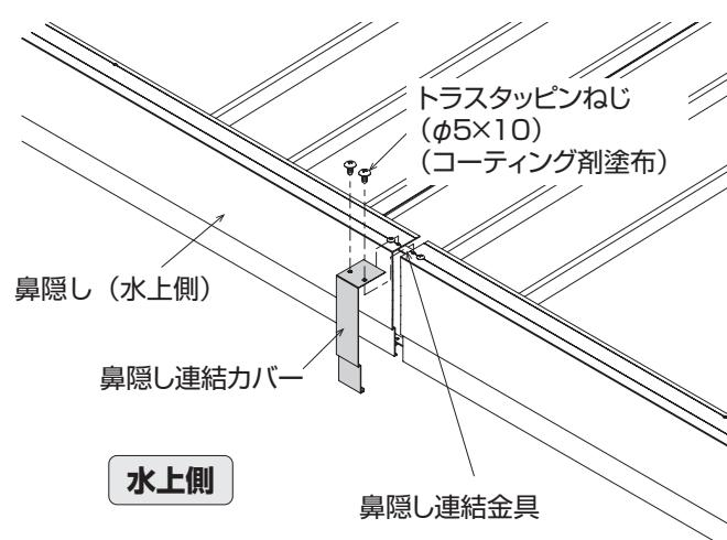
**7 鼻隠し補強部品（水上）を鼻隠し（水上側）に取り付けてください。**
