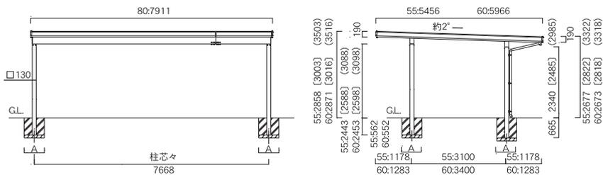
・耐積雪100cm(1台用・2台用：4本柱 / 3台用：8本柱)(3000N/m<sup>2</sup>)タイプ
