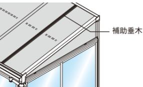
※間口1.0間に吊下げ式物干しを取り付ける際や、屋根部の補強にご使用ください。
