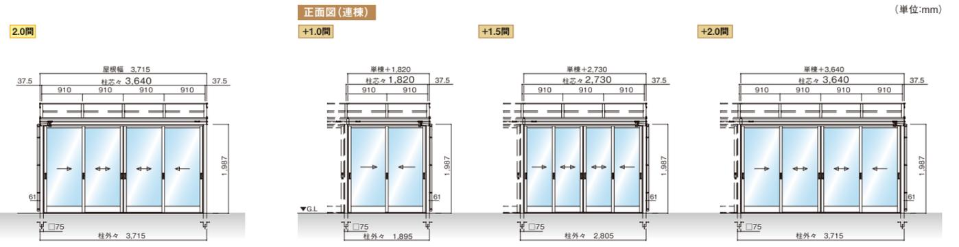
(注) 正面図はFタイプを表します。(注) 出幅9尺・積雪50cm使用の場合は、中間にタルキが入りタルキ幅が45mmになります。
