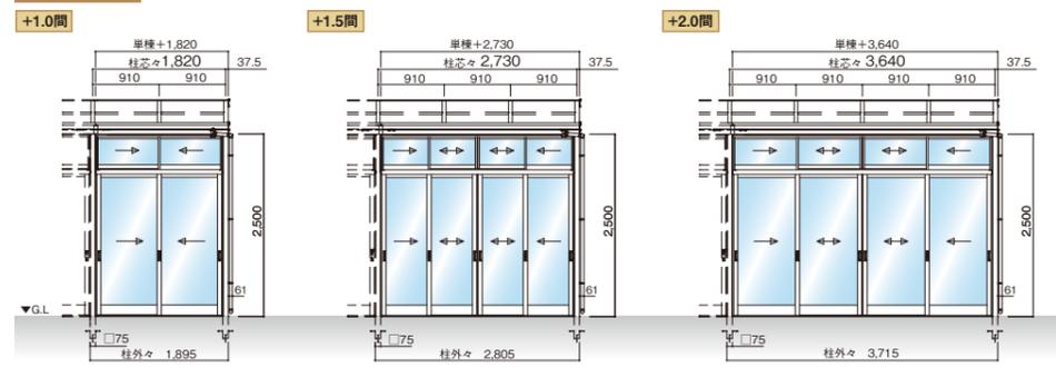
(注) 正面図はFタイプを表します。(注) 出幅9尺・積雪50cm使用の場合は、中間にタルキが入リタルキ幅が455mmになります。
