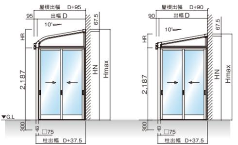
(注) 出幅3尺、4尺は2枚挿出しサッシではなく、FIXになります。
