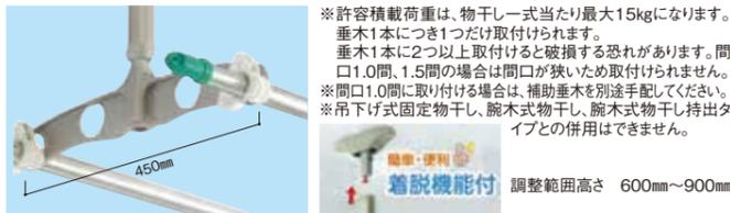
※許容積載荷重は、物干し一式当たり最大15kgになります。垂木1本につき1つだけ取付けられます。垂木1本に2つ以上取付けると破損する恐れがあります。間口1.0間、1.5間の場合は間口が狭いため取付けられません。※間口1.0間に取り付ける場合は、補助垂木を別途手配してください。※吊下げ式固定物干し、腕木式物干し、腕木式物干し持出タイプとの併用はできません。
