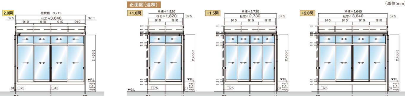
(注) 正面図はFタイプを表します。(注) 出幅9尺・積雪50cm使用の場合は、中間にタルキが入りタルキピッチが455mmになります。
