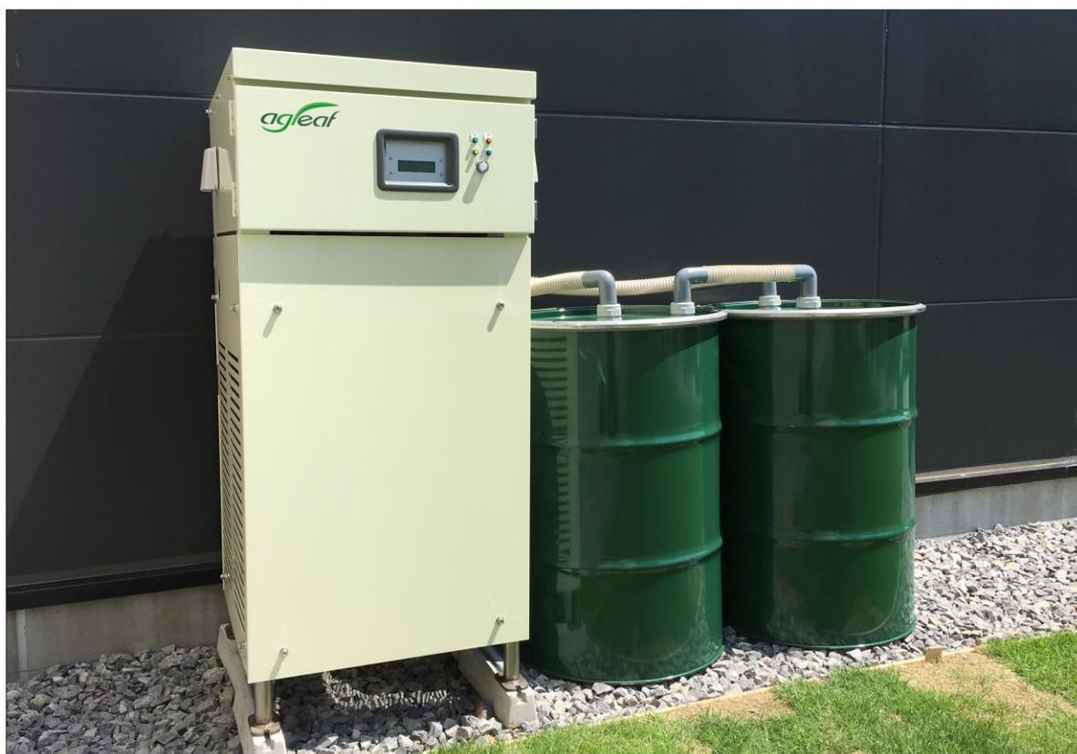
ハウス栽培用 CO<sub>2</sub>貯留・供給装置 ‘agleaf<sup>®</sup>’ (アグリーフ)は暖房機の排気ガスを浄化し、CO<sub>2</sub>のみを取出し、貯留・供給する装置です。元々排出されていたCO<sub>2</sub>を再利用するため、従来の燃焼方式のCO<sub>2</sub>発生機のように新たな燃料を必要とせず、大気中へのCO<sub>2</sub>排出量も削減できる環境に配慮した製品です。また、排気ガス由来のCO<sub>2</sub>にもかかわらず、熱くないため、ハウス内気温を上昇させることはありません。
